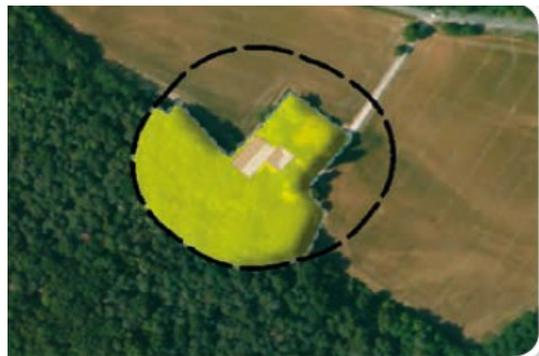
Autour des constructions : une attention particulière est apportée dans le rayon de 10 m autour des constructions. Il faut supprimer les arbres en densité excessive pour mettre à distance les houppiers (cimes et branchages) à au moins 2 m des constructions. Aucune branche ou partie d'arbre ne doit surplomber la toiture.
